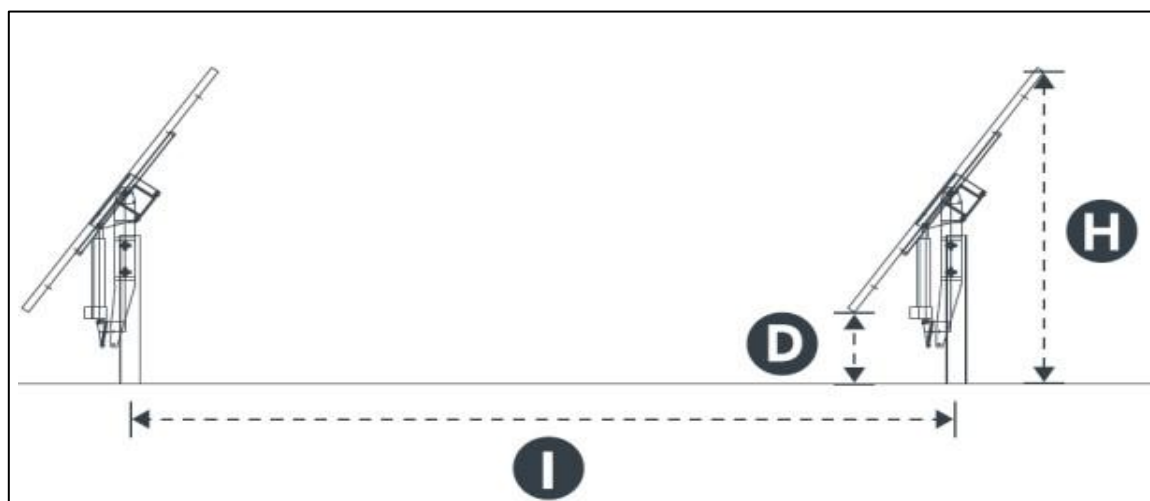
Figura 4: Profilo inseguitori monoassiali Est-Ovest
